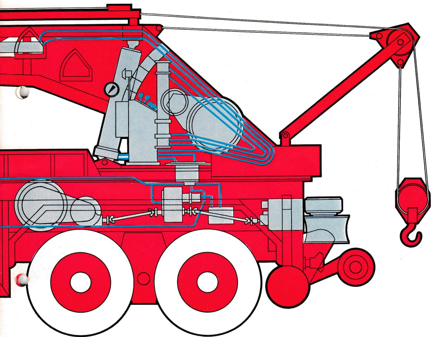
Trotz der geradezu unverwüchtlichen Konstruktion aller wichtigen Teile dieses Kranwagens gibt es eine Reihe von ideal gelösten technischen Feinheiten. So kann der Kran um 360° ohne Anschlag geschwenkt werden. Alle Kranbewegungen, wie Aufrichten und Ablegen des Kranauslegers, Drehen des Kranauslegers sowie
