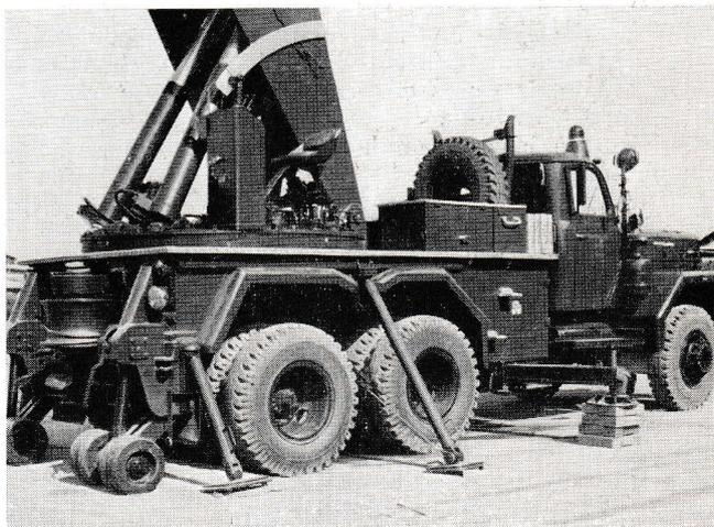
Bild 13: Abstützungen für Arbeiten nach rechts.
