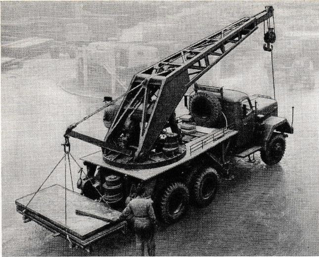
**Bild 7:** Durch Wippen des Auslegers hebt der Abschleppgalgen eine zu verführende Last von 5 t.
