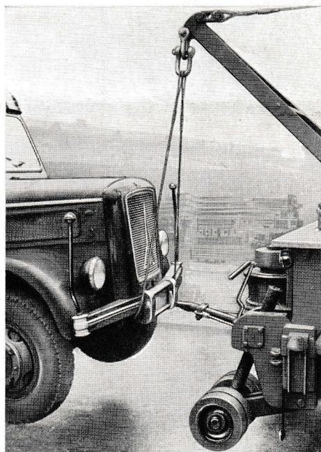
Bild 16: Verfahren einer Last von 5 t mit dem Abschleppgalgen.
