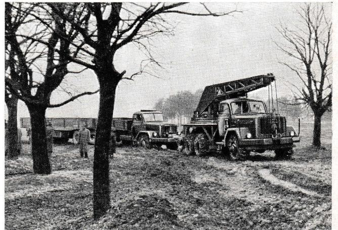
**Bild 10:** Abschleppen aus schwierigem Gelände in direktem Zug von 15 t.
