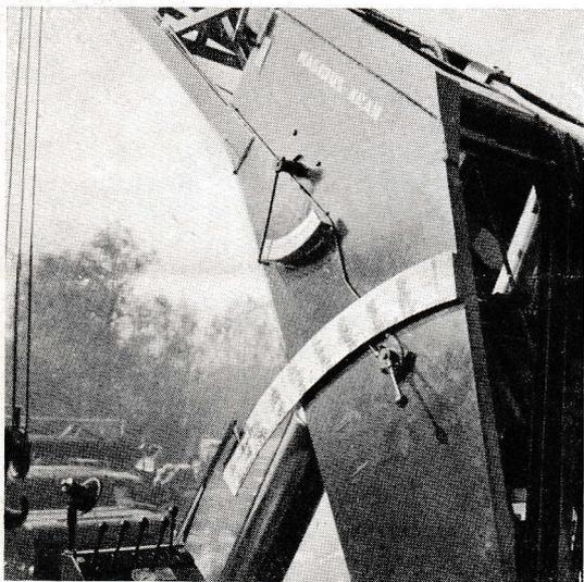
**Bild 9:** Belastungsanzeiger, darunter Neigeskala und Bedienung des Arbeitsscheinwerfers.
